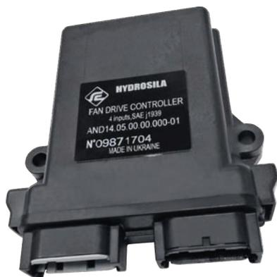
Блок управления (контроллер) гидропривода вентилятора предназначен для управления оборотами вентилятора в составе системы охлаждения двигателя. Контроллер защищен термостойким пластиковым корпусом, диапазон рабочих температур от -55°C до +125°C. Стандарт защиты IP67.
